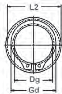
Diámetro Límite y Diámetro de Calibración Liberados en la Ranura
