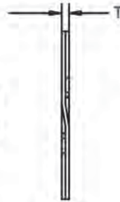
Diámetro libre y las mediciones del anillo
