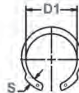
Medición del diámetro libre (Df) Serie DHI Df = D1 + 2S
