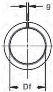
Diámetro libre y dimensiones del anillo con sección B-B
