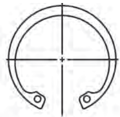
Diseño de orejas alternativo para tamaños mayores (opción del fabricante)
