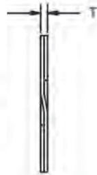
Diámetro libre y las mediciones del anillo
