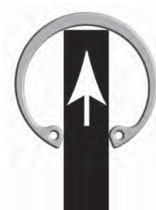
Figura A - Esta es la forma preferida de transferir un anillo interno a una carcasa de sección cónica insertando el mecanismo entre las orejas.
