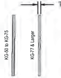
Diámetro libre y las mediciones del anillo
