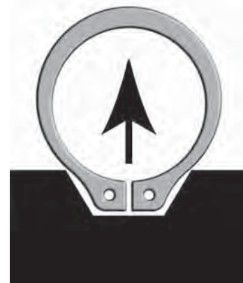
Figura B - Esta es la forma preferida de transferir un anillo externo a un mandril de sección cónica utilizando deslizador con un recorte complementario de las orejas.
