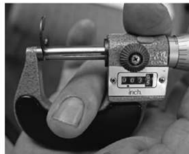
← Benutzen Sie eine Messschraube um die Dicke eines Rings zu bestimmen.
