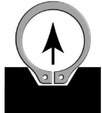
Figure B - Die bevorzugte Methode um einen Sicherungsring für Wellen auf einen konischen Dorn zuführen ist mit Hilfe einer Führungsschiene die einen Ausschnitt für die Augen hat
