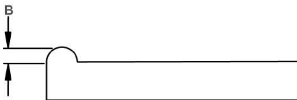
Für jede Sicherungsringgröße (B=Stanzgrat)
