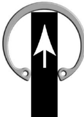
Abbildung A- Die bevorzugte Methode um einen Sicherungsring für Bohrungen in eine konische Hülse einzuführen ist, dass man eine Führungsschiene zwischen den Augen einsetzt.
