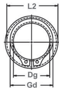
直径间隙&安装在沟槽 时的扣环外径
