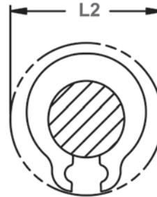
直径间隙 (当安装在沟槽时)
