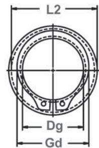
直径间隙&安装在沟槽时的扣环外径
