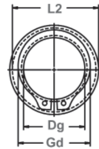
Diamètre de tolérance et largeur de l'écart relâché dans la gorge
