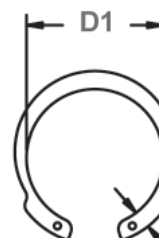
Mesure du diamètre libre (Df) Séries HOI Df = D1 + 2 (S \max)
